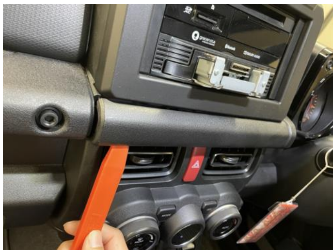
↑ナビパネル下のパネルを外します。
