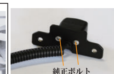
※2 バックカメラ取付ステー装着図
