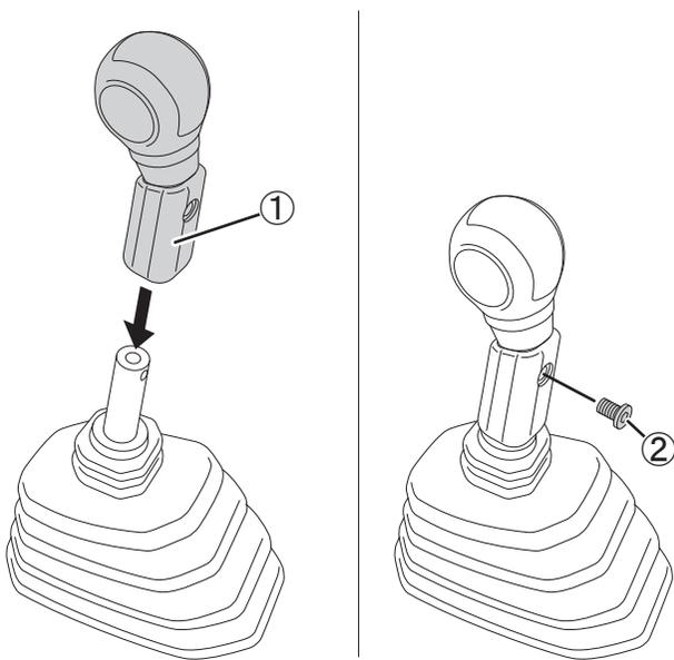
5. シフトノブを取り付けたトランスファーノブエクステンション①を、ボルト②でシフトレバーに取り付けます。
