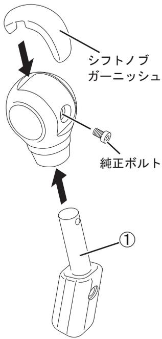
3. トランスファーノブエクステンション①にシフトノブを挿入し、純正ボルトで取り付けます。
