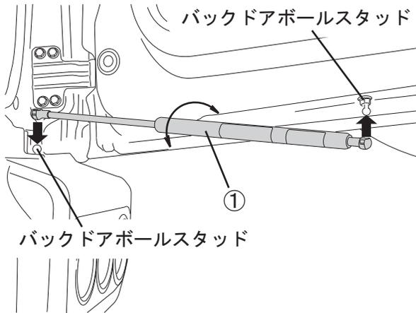
2. フリーストップドアオープナー①を、車体側→ドア側の順で、バックドアボールスタッドに取り付けます。
