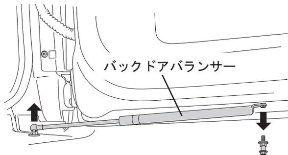
1. サービスマニュアルに従って、左右テールランプASSY、リアバンパーカバーを取り外し、バックドアバランサーを取り外します。
