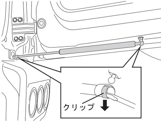
1. マイナスドライバーでクリップを外し、バックドアダンパーを、バックドアボールスタッドから取り外します。
