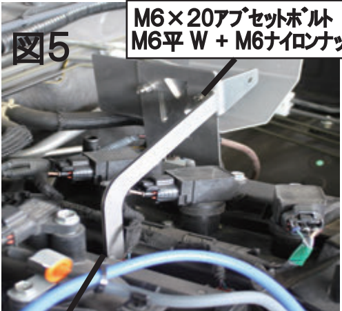
M6 × 20アブセットボルト M6平 W + M6ナイロナット 純正ボルト(締付トルク7.5N・m)
