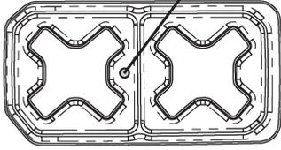
2. クロステールガーニッシュ 裏面、両面テープのリケイ紙を剥がし、テールランプ中心側、上下のフチに合わせて クロステールガーニッシュ を圧着します。
